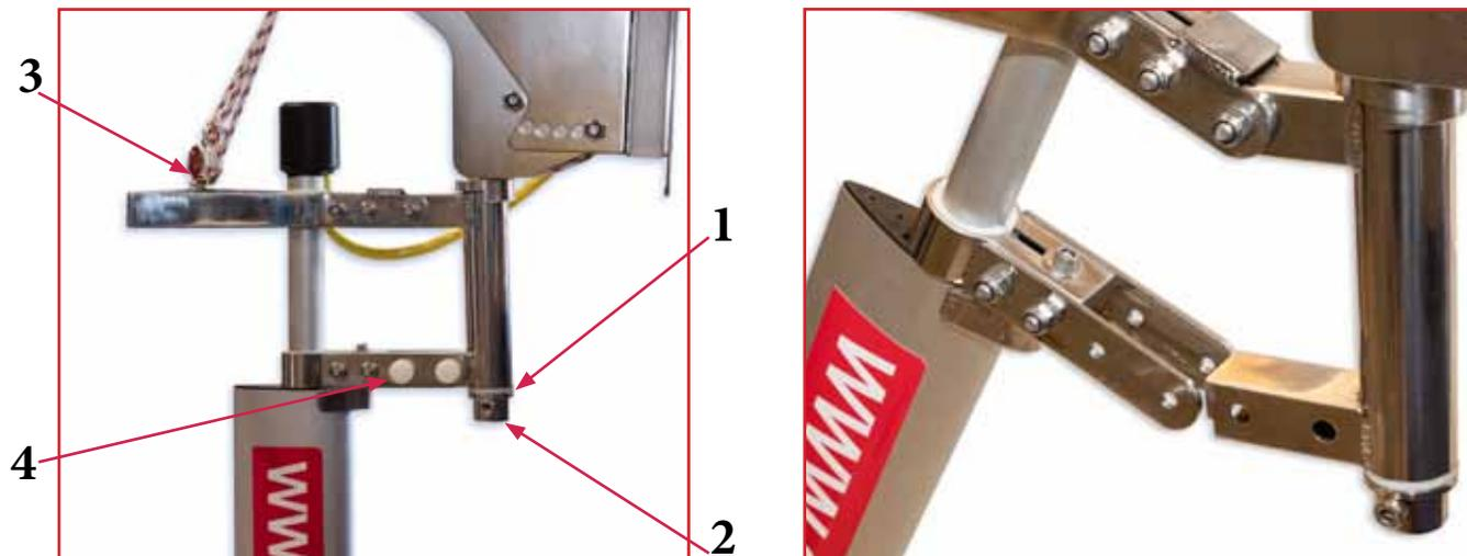
Umlenckblock mit den 3 Leinen auf der gewünschten Seite in die vorgesehene Bohrung (Pos. 3) einschrauben und gut festziehen. (es ist auf jeder Seite eine Bohrung vorhanden) Dadurch dreht sich der Generatorteil beim Hochziehen auf die gegenüberliegende Seite und kann nicht an der Mechanik anstehen. Die Seite kann frei gewählt werden, je nach Platz an Bord.
