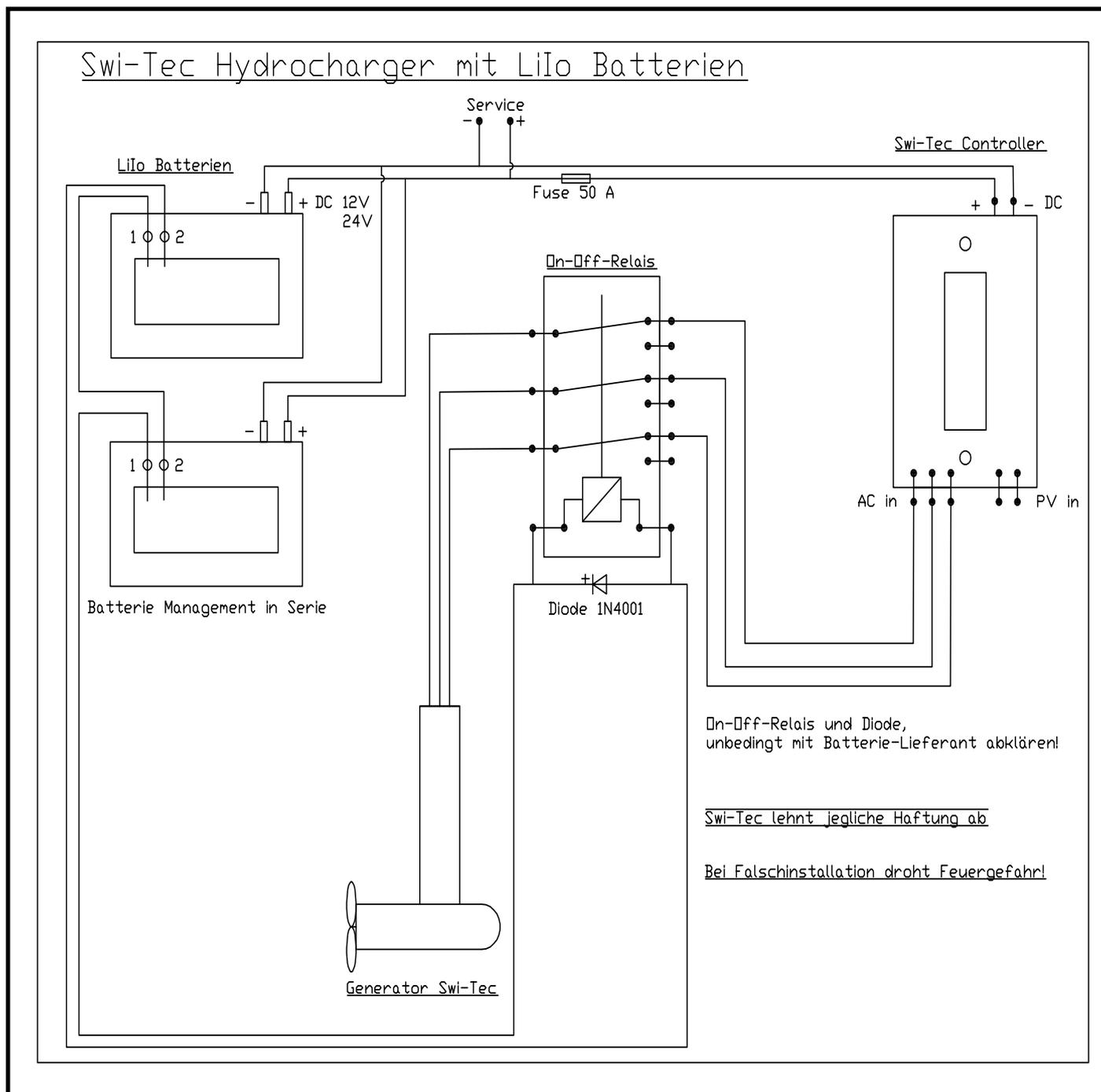
Das Steuergerät wird mittels vier Schrauben in der trockenen Kabine in der Nähe der Batterien so angebracht, dass man die digitale Anzeige gut sehen kann. Die Batteriekabel sollten nach Möglichkeit kurz
