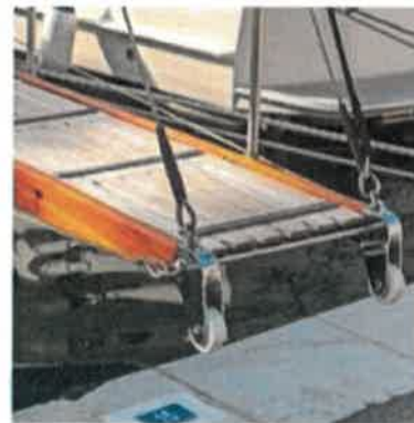
Für Motoryachten gibt es Teleskop-Gangways, die werftmäßig so montiert werden, dass sie bei Nichtgebrauch im Heck verschwinden.
