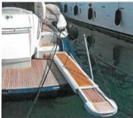
Für Motoryachten gibt es Teleskop-Gangways, die werftmäßig so montiert werden, dass sie bei Nichtgebrauch im Heck verschwinden.
