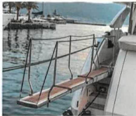
Für Motoryachten gibt es Teleskop-Gangways, die werftmäßig so montiert werden, dass sie bei Nichtgebrauch im Heck verschwinden.
