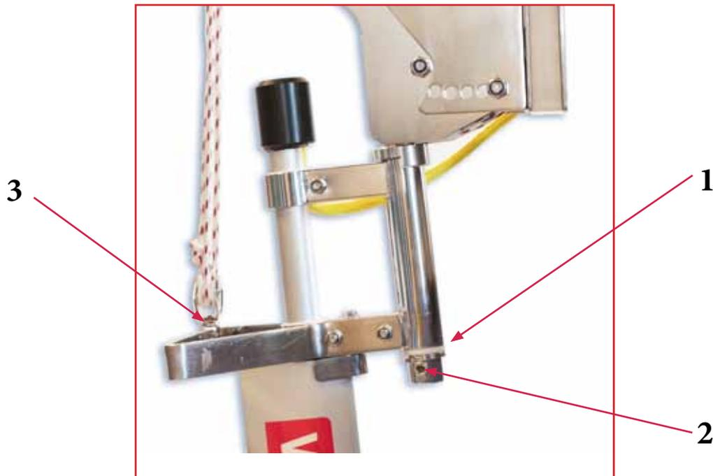
Umlenckblock mit den 3 Leinen auf der gewünschten Seite in die vorgesehene Bohrung (Pos. 3) einschrauben und gut festziehen. (es ist auf jeder Seite eine Bohrung vorhanden) Dadurch dreht sich der Generatorteil beim Hochziehen auf die gegenüberliegende Seite und kann nicht an der Mechanik anstehen. Die Seite kann frei gewählt werden, je nach Platz an Bord.
