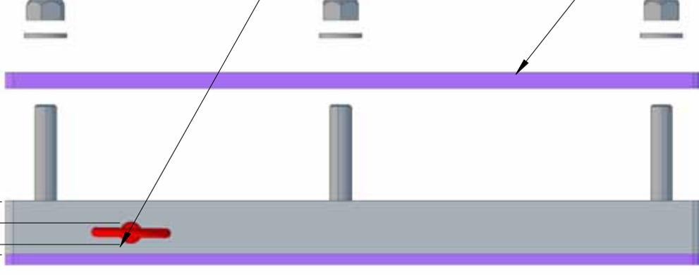
Schmäler Teil des Sicherungsbolzens auf der Seite vom Hydro Charger (Vorsicht: Bohrung ist seitlich versetzt)
