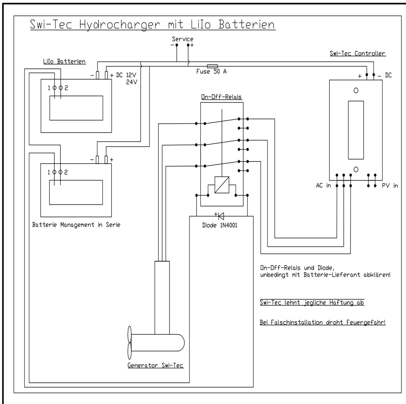
Das Steuergerät wird mittels vier Schrauben in der trockenen Kabine in der Nähe der Batterien so angebracht, dass man die digitale Anzeige gut sehen kann. Die Batteriekabel sollten nach Möglichkeit kurz sein. Plus (+) des Gerätes „Battery“ mit rotem Kabel am Plus der Batterie anschliessen, das schwarze Ka-
