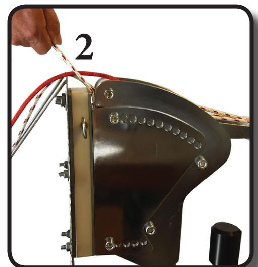
6. Hydro Charger mit der Zugleine (2) durch ruckartiges Ziehen in der Arbeitsposition blockieren. Dabei rastet die Sicherung (rote Leine) ein und der Zug auf allen Leinen wird entlastet.
