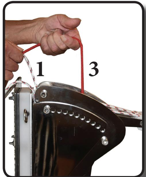
8. Hochziehen: an der Holeleine (1) gleichmäßig ziehen. Die rote Auslöseleine (3) kann dann losgelassen werden.
