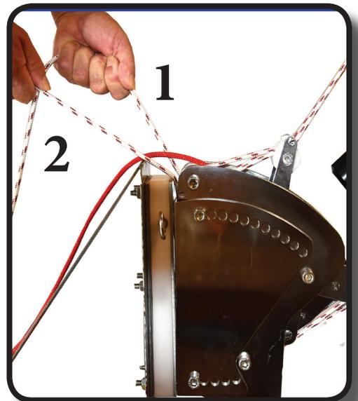
**5. Hydro Charger bis zum Anschlag in senkrechte Position mit der Zugleine (2) heranziehen.**
