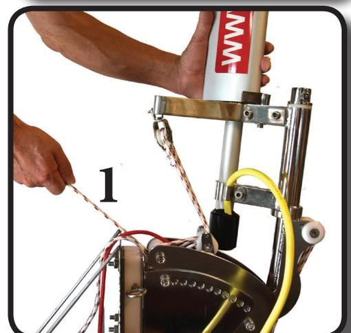
**3. Hydro Charger mit der Holeleine (1) geführt herunterlassen. (nicht fallen lassen)**
