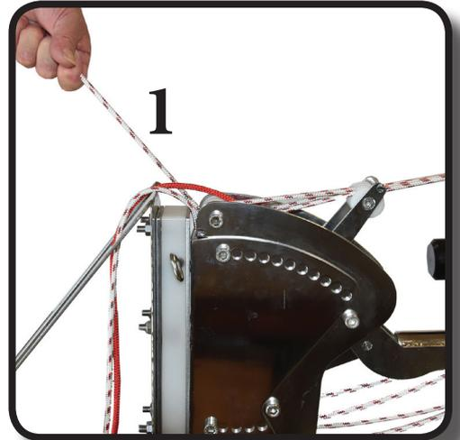
**4. Hydro Charger mit der Holeleine (1) kontrolliert ablassen. Dabei die hintere lose Zugleine (2) gleichmässig nachziehen.**
