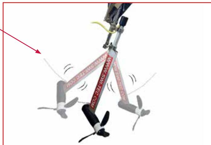
Am Segment kann durch verschiedene Bohrungen die Neigung vom Spiegel (auch bei Negativspiegel) so eingestellt werden, dass der Hydro Charger Light in vertikaler Position im Wasser steht. (Bild)
